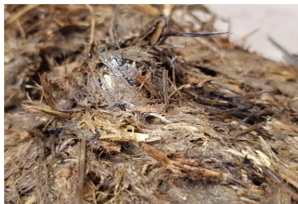
Abbildung 3-12: Gute Kopplung bei Abdruck der Senkung in relativ kurzhalmigem und unverholztem Pressgut.
